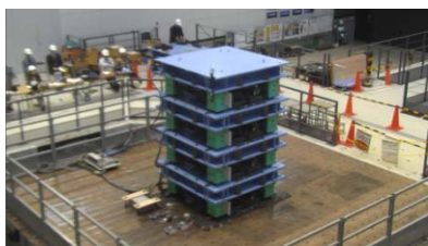
写真1： センサ性能検証振動台実験（写真提供：清水建設）
