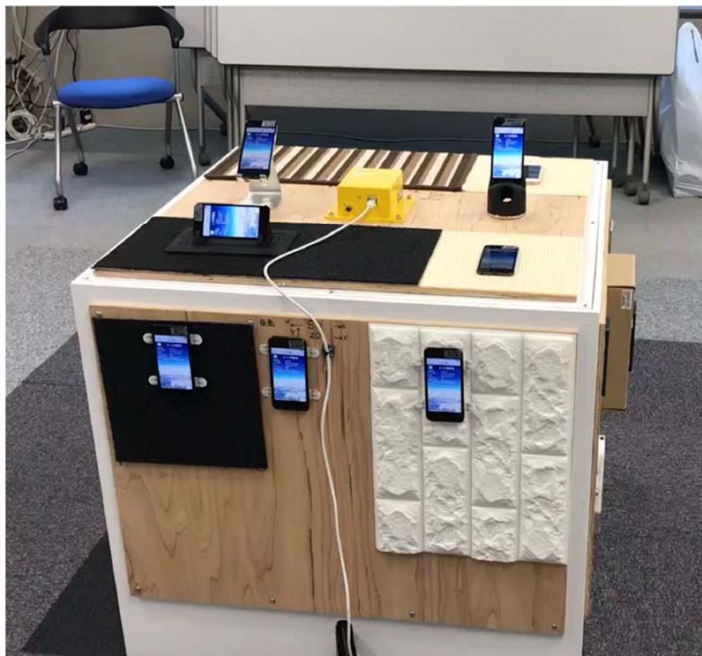
図 2 市販治具（試作版）加振実験の様子
